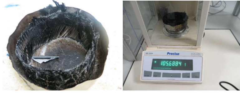
Şekil 4.44. Numunelerin yakma testinden sonraki hali ve hassas terazide tartılması
