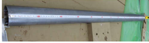
Şekil 3.2. Parlatılmış çelik kalıp, L= 1300 mm, d= 72 mm, t= 4 mm
