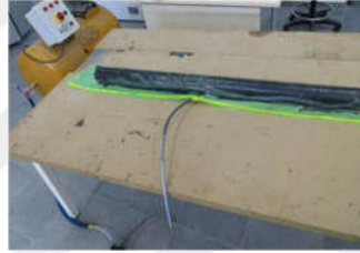
Şekil 3.5. İmalattan sonra nano takviyeli boru için vakum işlemi.
