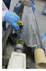
Şekil 3.4. Kalıp üzerine kumaş sararak kompozit boru üretimi
