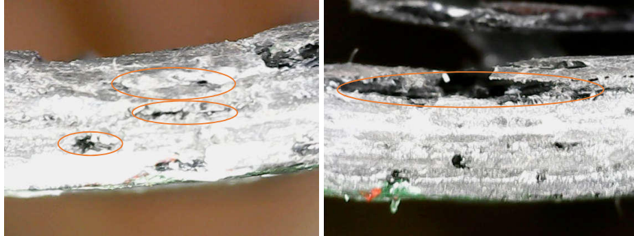
Şekil 4.21. Katkısız kompozit boru 10 J enerji seviyesi darbe testi sonrası yandan kesit dijital mikroskop görüntüsü.
