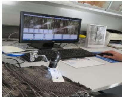
Şekil 4.18. Karbon fiber kumaşın Dijital Mikroskop görüntüsü (Ölçek 1mm).
