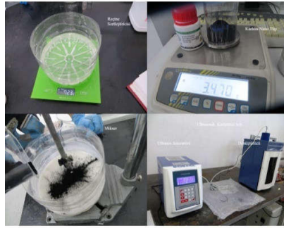
Şekil 3.3. Reçine sertleştirici, (a) KNT ve nanokil mekanik karıştırma, (b) ultrasonla karıştırma
