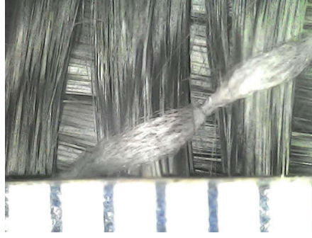
Şekil 4.19. Karbon fiber kumaşın Dijital Mikroskop görüntüsü (Ölçek 1mm)
