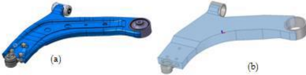
Şekil 2.10. Alt kontrol kolu mevcut metal tasarımı (a) ve ilk konsept tasarımı (b) (AbdulRahman ve Salleh, 2018)
