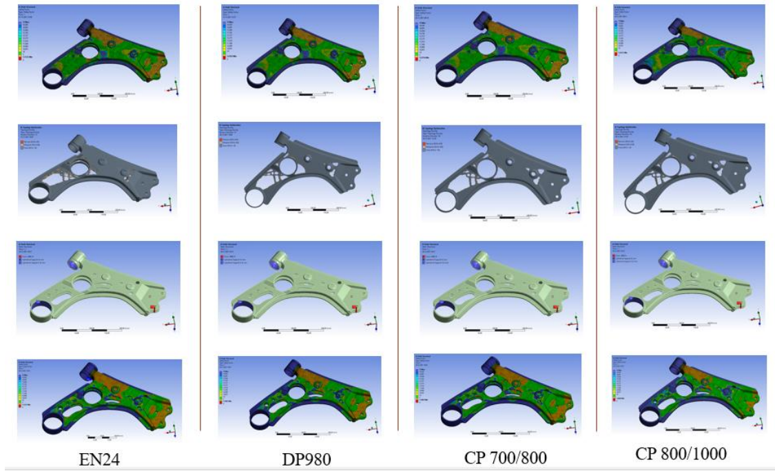
Şekil 7.1. Malzeme çeşitlerine göre topoloji optimizasyonu aşamaları
