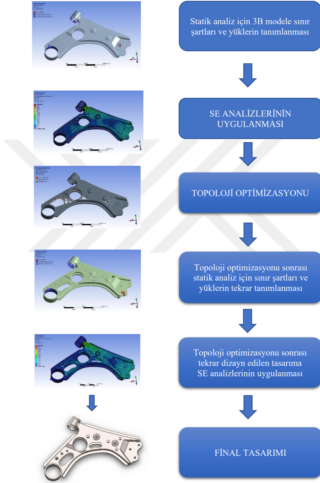
Şekil 6.5. Alt askı kolu için topoloji optimizasyonu süreci
