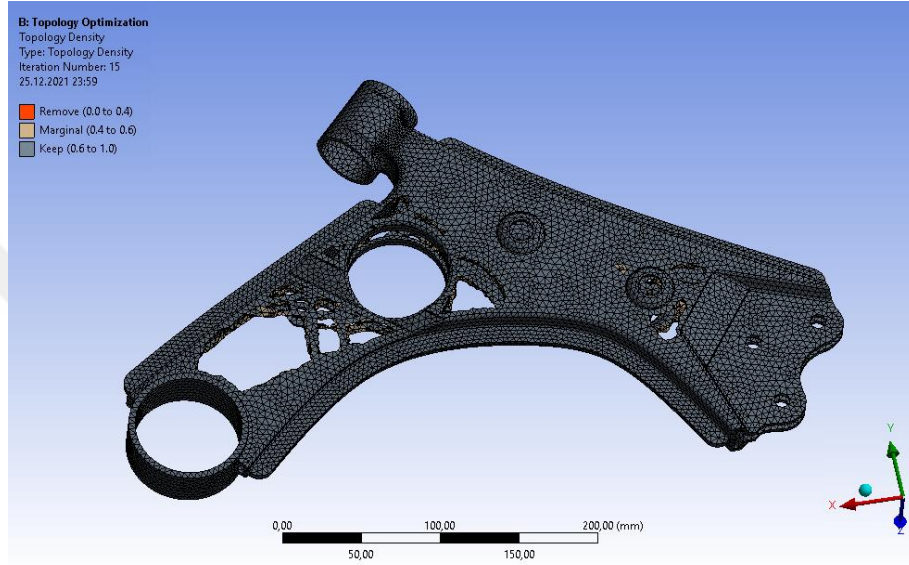
Şekil 6.15. DP980 malzemesi için Ansys'de yapılmış topoloji optimizasyonu
