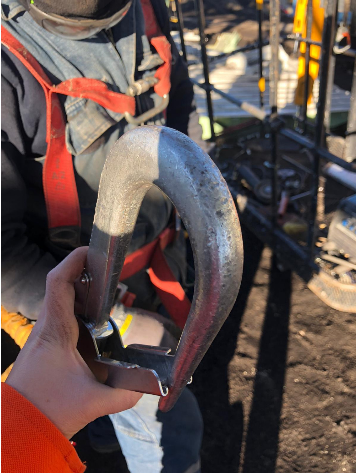
Şekil 3. 22. Emniyet Kemer Arızalı/Bozuk
