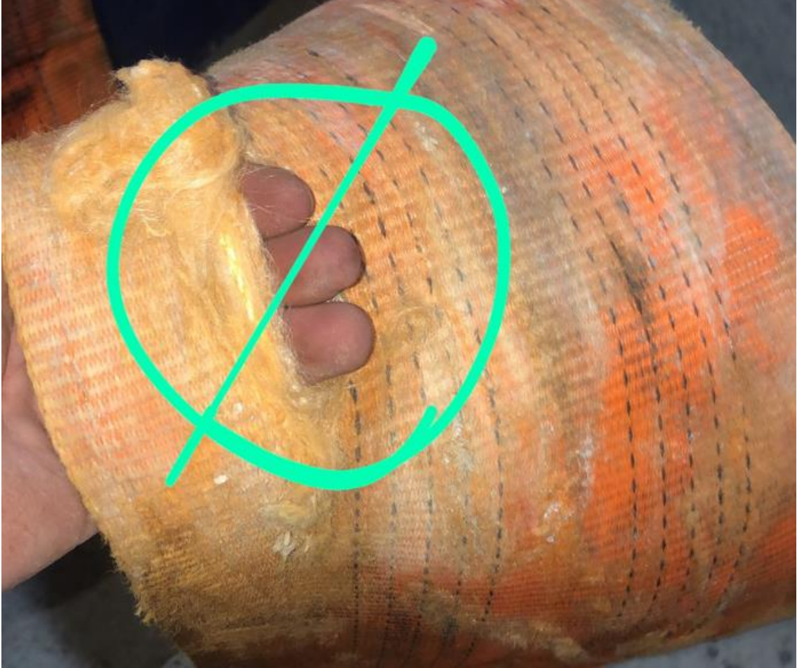
Şekil 3. 30. Hasarlı Kaldırma Ekipmanı
