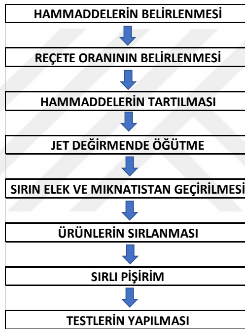
Şekil 3.2: Standart Sırlar ve RO 2 İçeren Seramik Sırların Proses Şeması
