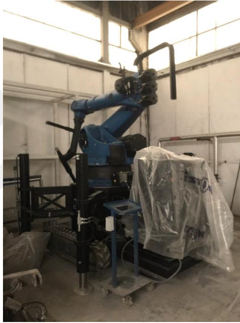
Şekil 5.3 Konut üretiminde kullanılan üç boyutlu yazıcı
