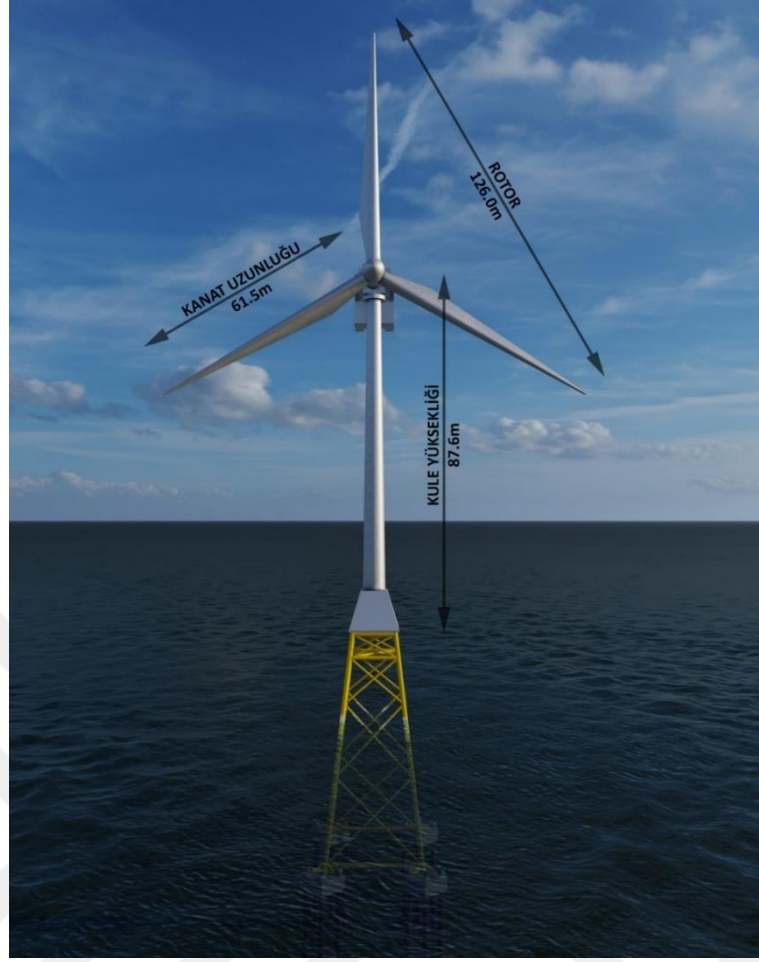
Şekil 3.9. Rüzgâr türbini boyutsal parametreleri
