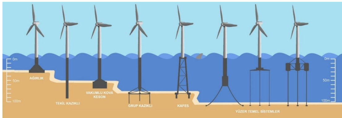
Şekil 3.2. Açık deniz rüzgâr türbinleri temel tipleri
