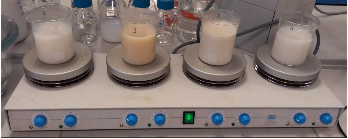
Şekil 2.3 Nanokiller ve sürfaktanların manyetik karıştırıcıda karıştırılması
