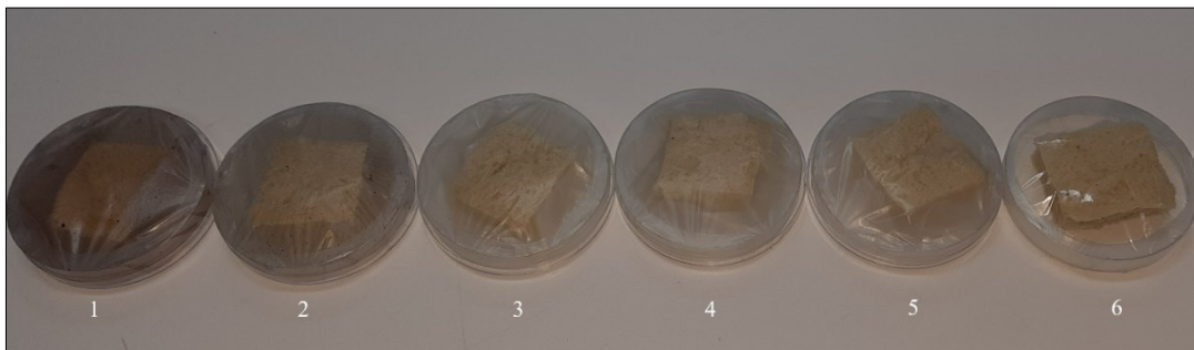
Şekil 2.8 PKN ile kaplanmış ekmek örnekleri 1) PCL-MMT+CTAB20+Ag, 2) PCL-HNT+CTAB10+Ag, 3) PCL-MMT, 4) PCL-HNT, 5) Kontrol ve 6) LDPE film
