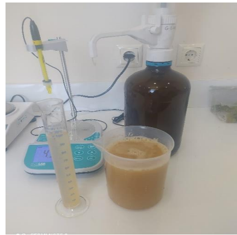
Şekil 3.3. Refraktometre (% KM), Ölçü Silindiri (Şıra Randımanı) ve Otomatik Büret (Asit Tayini) ve pH metre (pH ölçümü)
