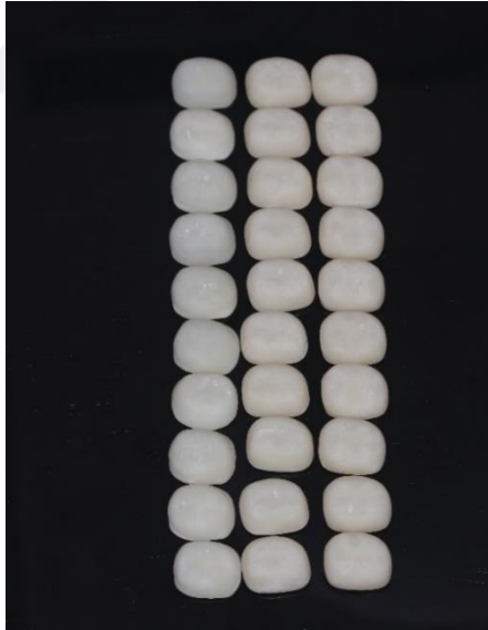
Şekil 3.14. Formlabs Form 3b SLA yazıcıda üretilen 0.5 mm, 1 mm ve 1.5 mm kalınlığındaki kronlar
