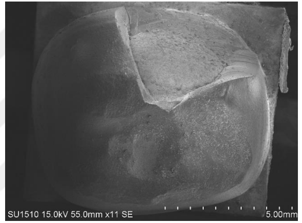
Şekil 4.1 Tip 1 kron kırığı örneği ve SEM görüntüsü
