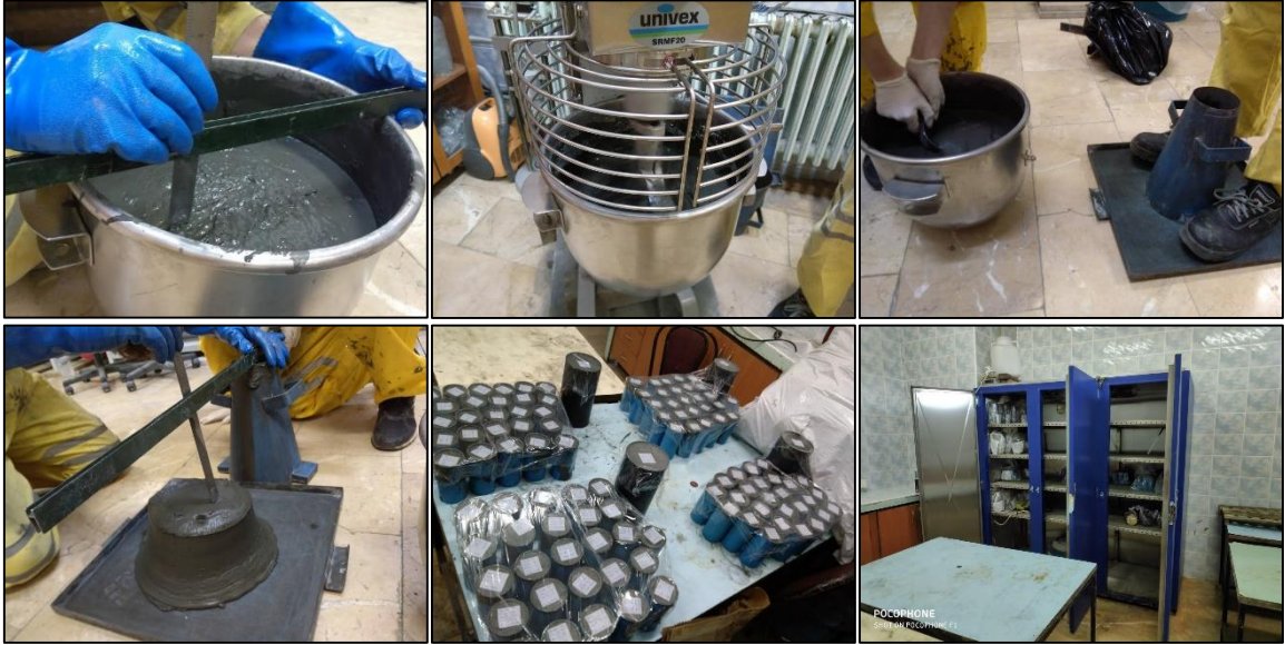
Şekil 6. Macun dolgu karışımı ve numunelerinin hazırlanması süreci
