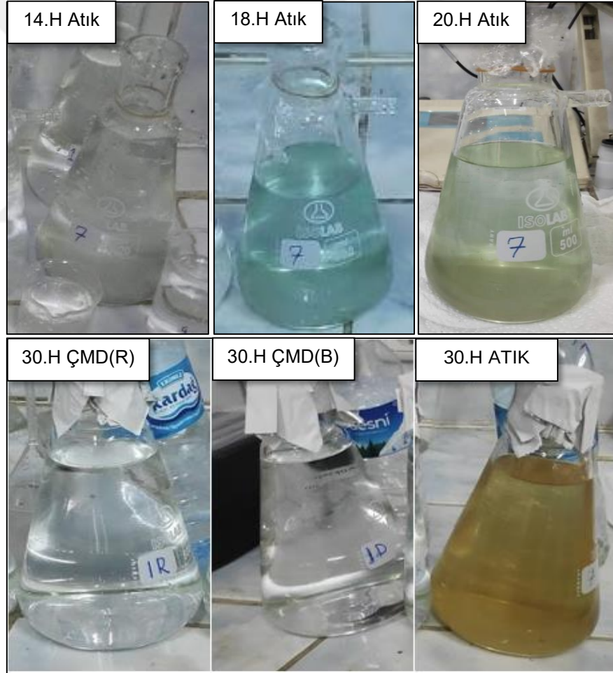
Şekil 16. Kinetik test sonucu atık malzemeye ait süzüntü suyunun zamana bağlı renk değişimi (H: Hafta)
