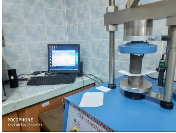
Şekil 7. Tek eksenli basınç dayanımı testlerinin gerçekleştirilmesi
