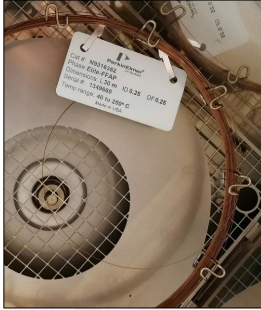
Şekil 3.2: Çapraz bağlı carbowax-PEG yapısına sahip FFAP GC kolonu.
