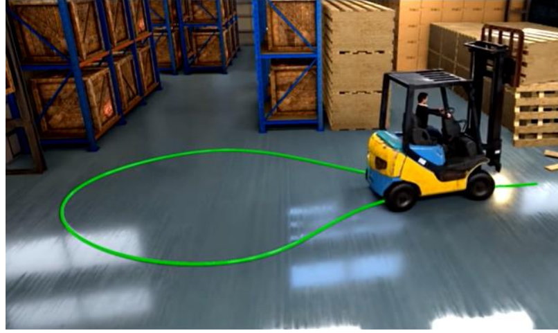
Şekil 4-2: Forkliftlerin dönüşü için kullandıkları alan [51]
