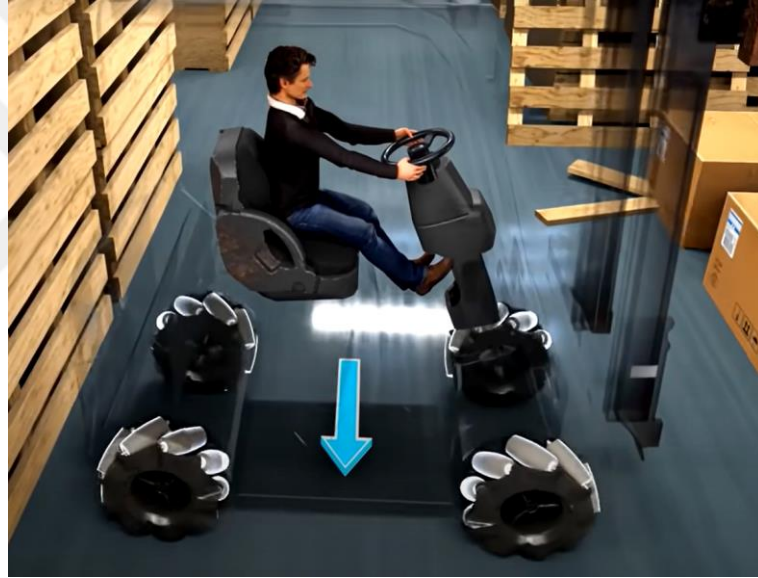
Şekil 4-3: Mecanum tekerleklerin manevra kabiliyetleri [51]
