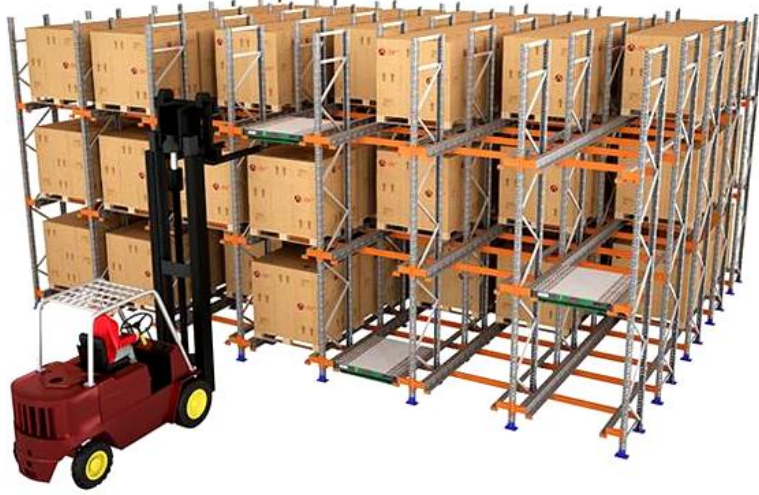
Şekil 2-16: Taşıyıcı robotlu akıllı raflar [21]
