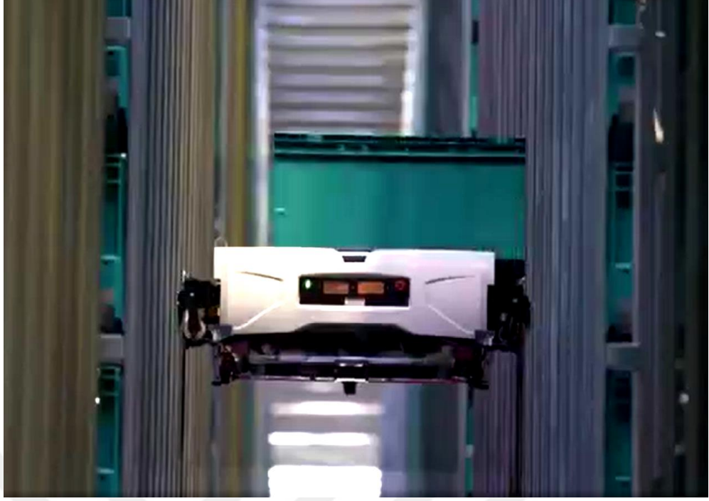
Şekil 3-21: EXOTEC firmasının ürettiği ODBS [47]
