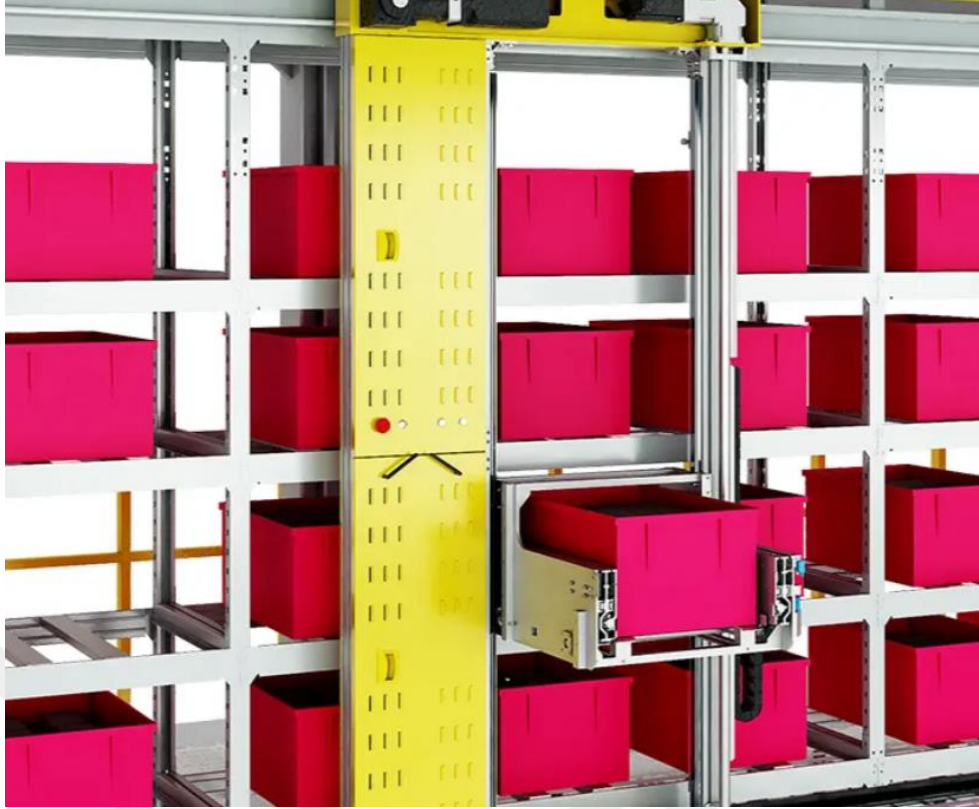
Şekil 3-14: 2 Eksenli taşımali koridor robota sahip ODBS örneği [40]
