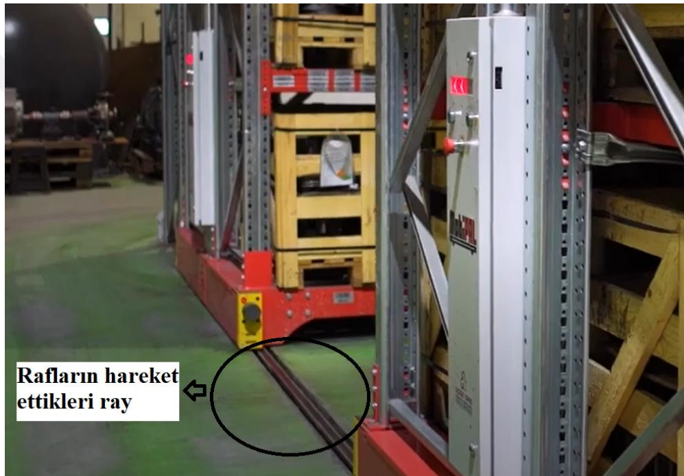
Şekil 3-17: Taşıyıcı robot ve koridor robotsuz yarı otonom sistem örneği [43]
