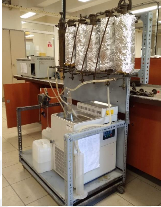
Şekil 3.5: Batarya tipi ekstraktör.
