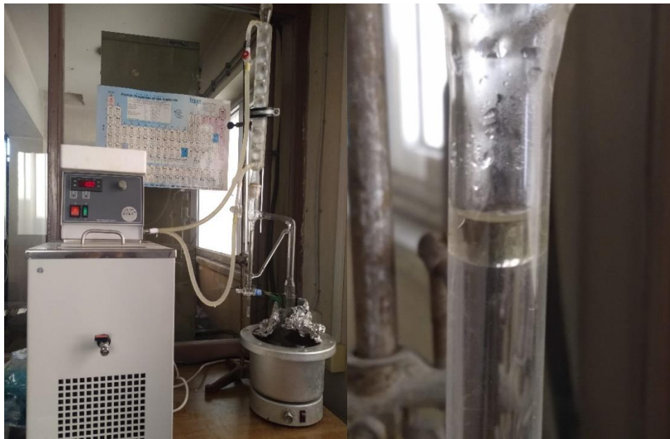
Şekil 3.9: Hidrodestilasyon işlemi (sağda) ve uçucu yağ (solda).
