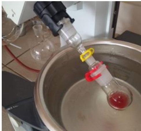
Şekil 3.6: Vakumlu döner buharlaştırıcı.
