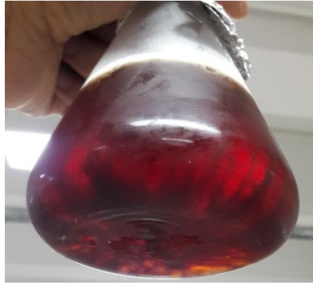
Şekil 4.22: HCl ile asitlendirilmiş metanolla bekletilen üründe çökelti oluşumu.
