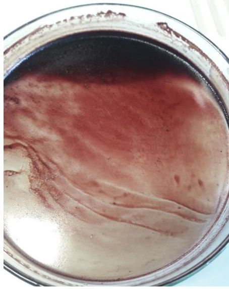
Şekil 4.21: Kolon kromatografisinden alınıp kurutulan ürün.
