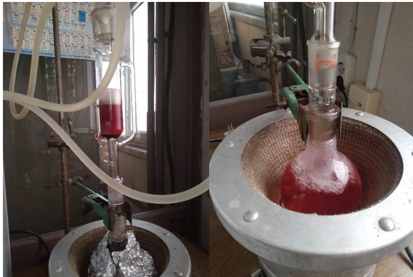
Şekil 3.11: Soxhlet ekstraksiyon işlemi.
