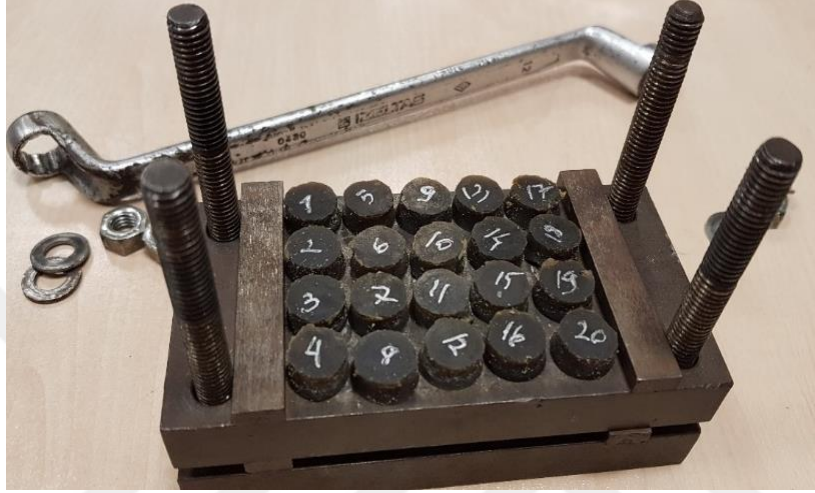
Şekil 4.8. Kalıcı deformasyon analizi için hazırlanan numuneler
