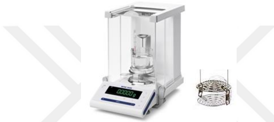
Şekil 4.3. Yoğunluk ölçmede kullanılan cihaz ve tümsek kit (URL-8)
