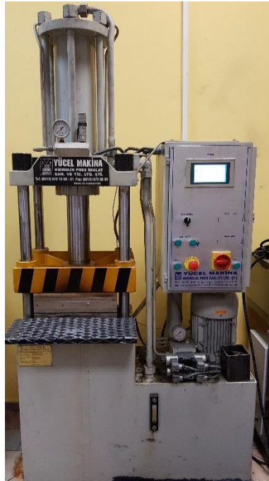
Şekil 4.4. Vulkanizasyonda kullanılan hidrolik pres
