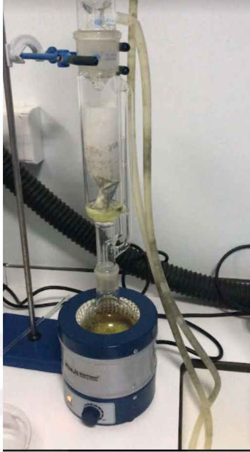
Şekil 3.1. Ekstraksiyonu yapılan bitkilerin soxhlet cihazındaki görüntüsü
