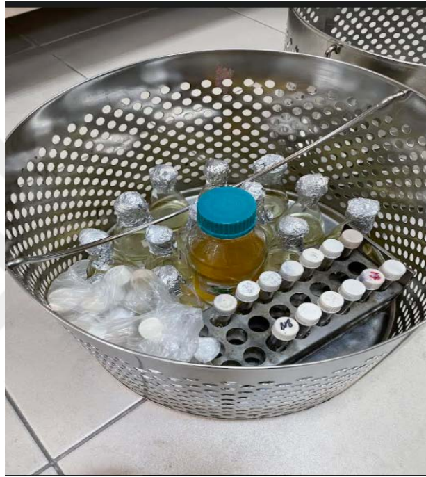
Şekil 3.3. Nutrient Broth besiyerinin otoklav için hazırlanması
