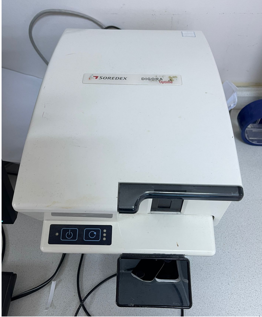
Şekil 14: Digora Optime UV fosfor plak tarayıcı (Soredex, Helsinki, Finland)
