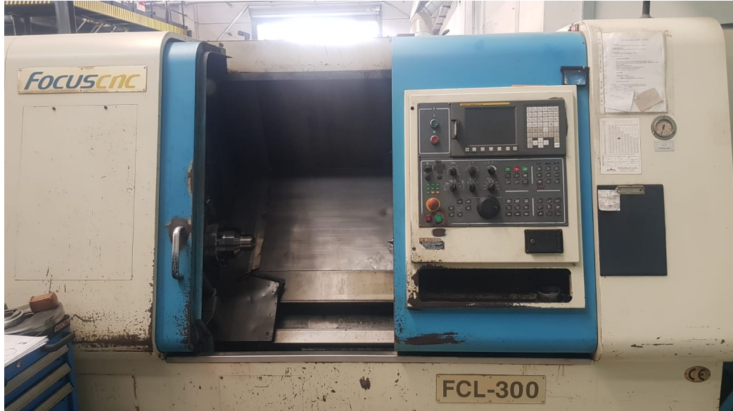
Şekil 4: Standart plastik halkaların üretildiği FocusCNC FCL-300 cihazı
