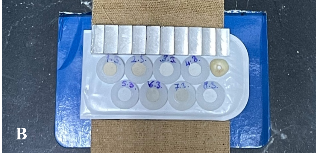
Şekil 11: A. Radyografi Düzenegi B. Fosfor plağa yerleştirilen örnekler, dentin ve Al step-wedge
