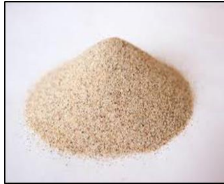
Şekil 3.5 RPB üretiminde kullanılan silis agregatı
