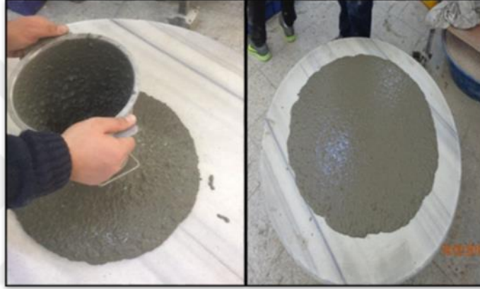
Şekil 3.9 YPB karışımlarında gerçekleştirilen çökme akış testi
