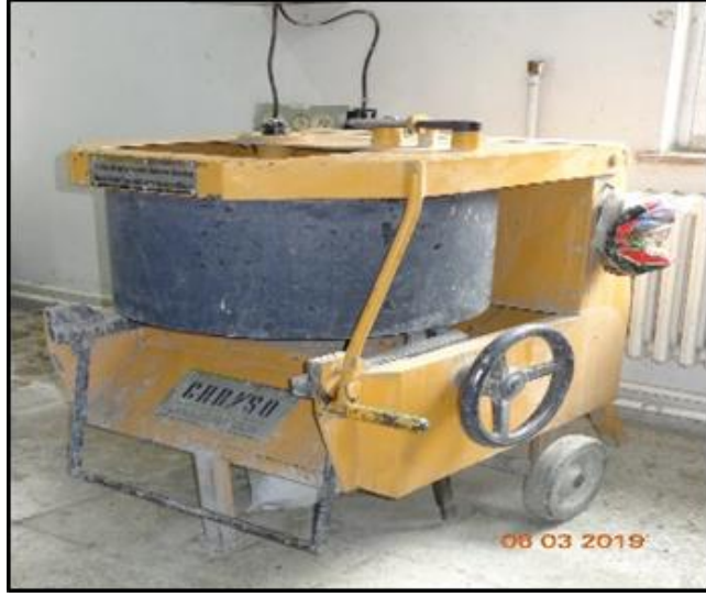
Şekil 3.7 RPB karışımlarını karıştırmak için kullanılan mikser
