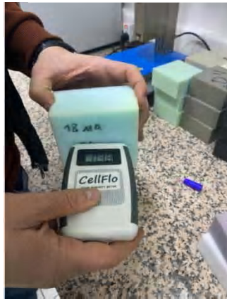
Şekil 10. Sünger hava geçirgenlik ölçümü a) 26 dansite b) 16 dansite c) 18 dansite
