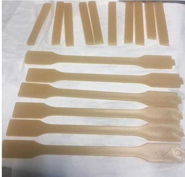
Şekil 6.5 Enjeksiyondan kalıbından çıkmış test çubukları
