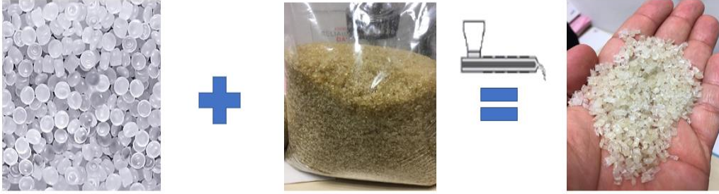
Şekil 6.3 TPS/PP harmanlarının hazırlanması
