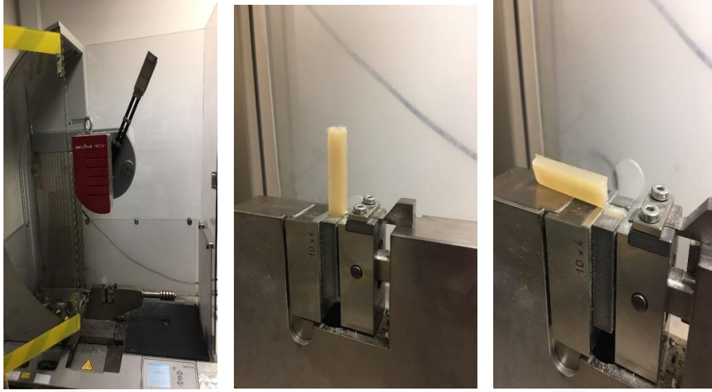
Şekil 6.8 TPS/PP çekme çubuklarının Zwick darbe izod cihazında test edilmesi
