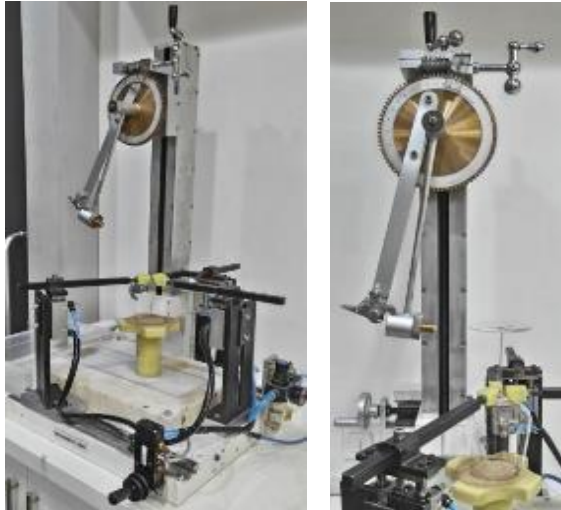
Şekil 5.10: Taban kısmından alınan cam numunelerin darbe dayanımını test etmek için kullanılan alet
