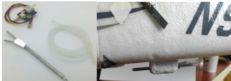
Şekil 3.26. Hava Hızı Sensörü 4525DO Analog Sensör ve pitot tüpü
