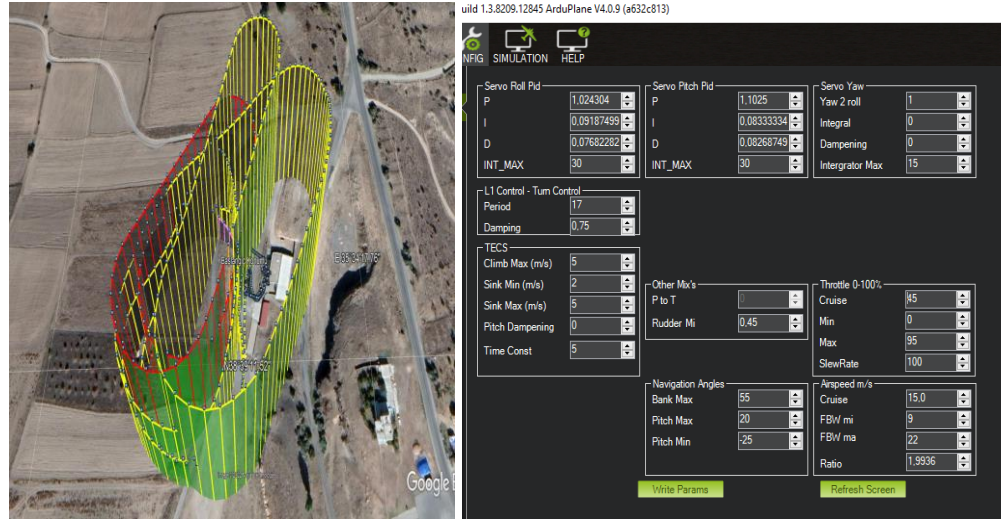
Şekil 5.66. Otonom uçuş için PID ayarı ve stabilize mod uçuş rotası
