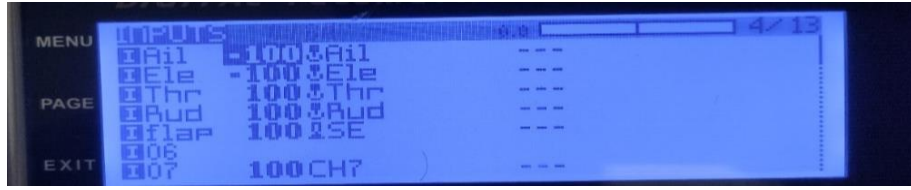
Şekil 3.11. Kumandaya atanan kanal girişleri ve PWM sinyallerinin ayarı
