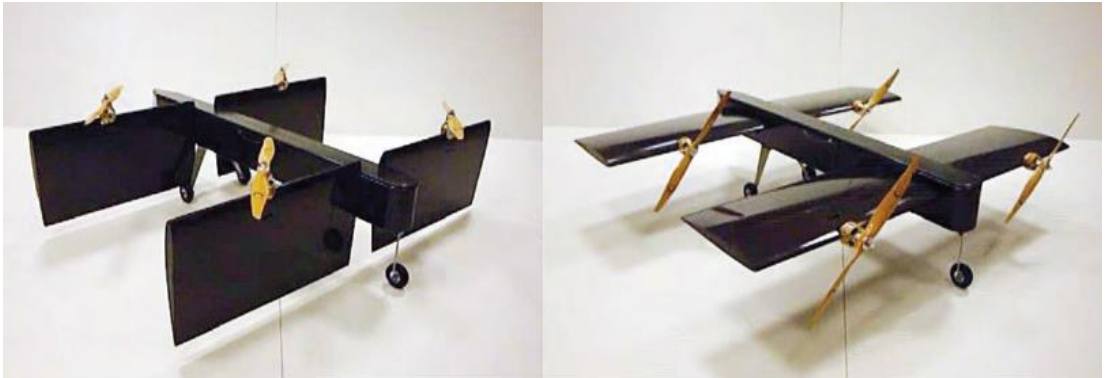
Şekil 1.5. Düşey iniş kalkışlı eğimli kanata sahip İHA modeli [20]
