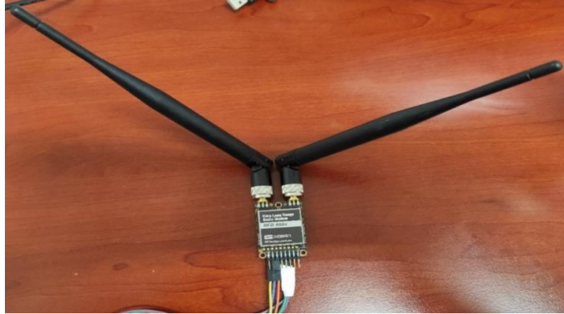
Şekil 3.14. 1/2 dipol antenli yer istasyon modemi ve polarizasyonu
