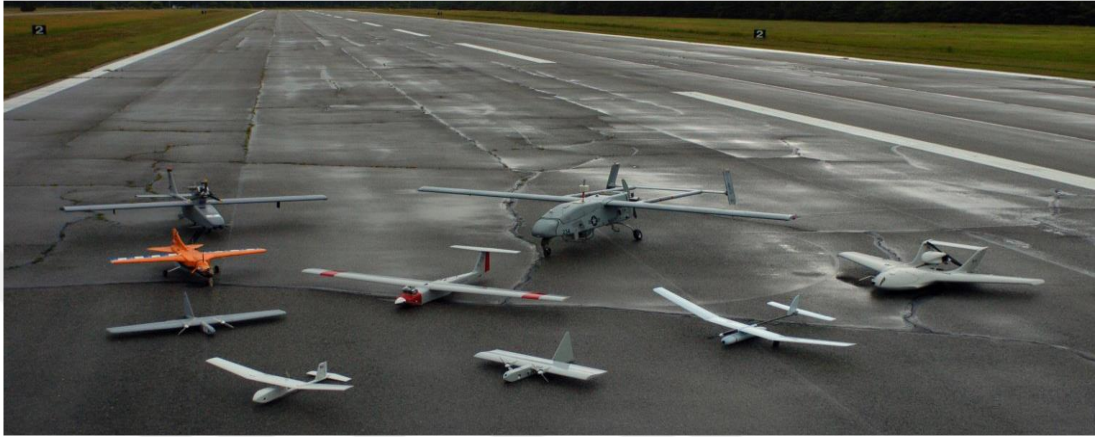
Şekil 1.10. Uçaklar (önden arkaya ve soldan sağa) RQ-11A Raven, Evolution, Dragon Eye, NASA FLIC, Arcturus T-15, Skylark, Tern, RQ-2B Pioneer, Neptune. US Savunma Birimi [33]
