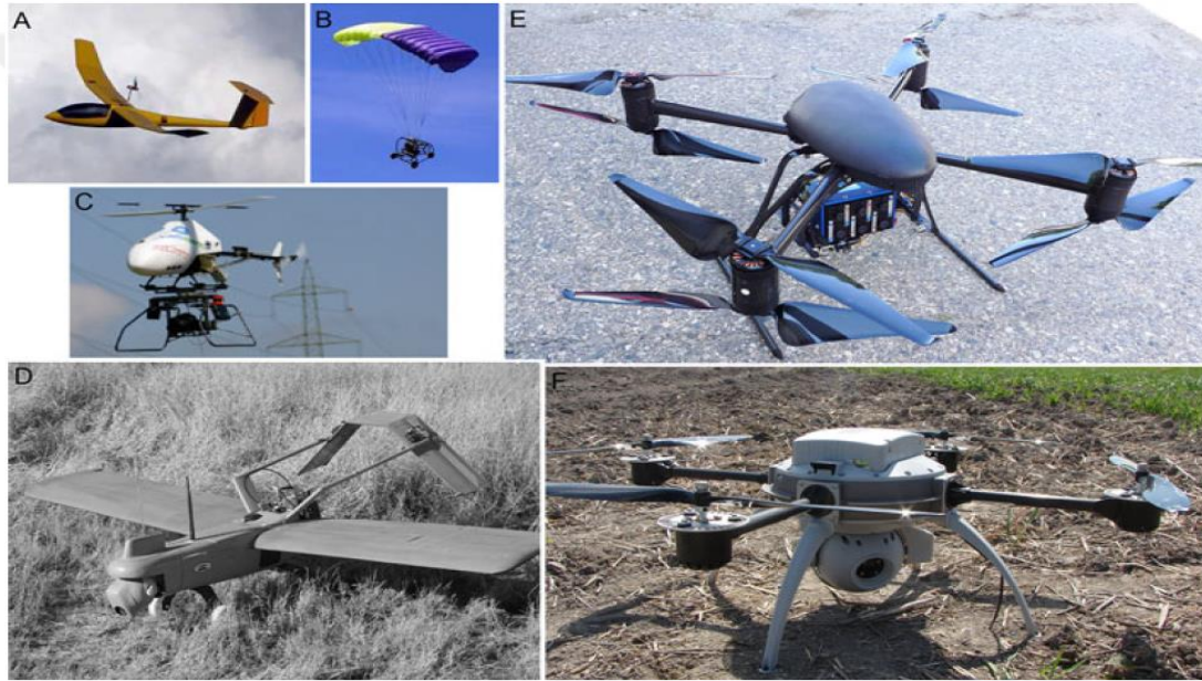
Şekil 1.7. İHA türleri A) sabit kanatlı B) paraşütlü C) helikopter D) sabit kanatlı E) Draganflyer X8 8 rotor helikopter F) Aeryon Scout 8 rotor helikopter [21]
