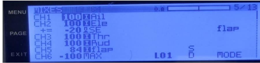
Şekil 3.12. Elevator ve flap etkilerinin oransal (mix) ayarları
