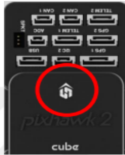
Şekil 3.5. Otopilot bağlantı ve uçuş yönü
