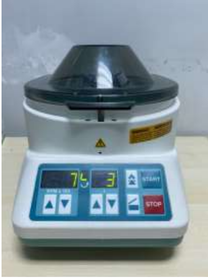
Resim 2 Santrifüj cihazına tüplerin dengeli olacak şekilde yerleştirilmesi ve devirin 700 rpm/3 dk ayarlanması
