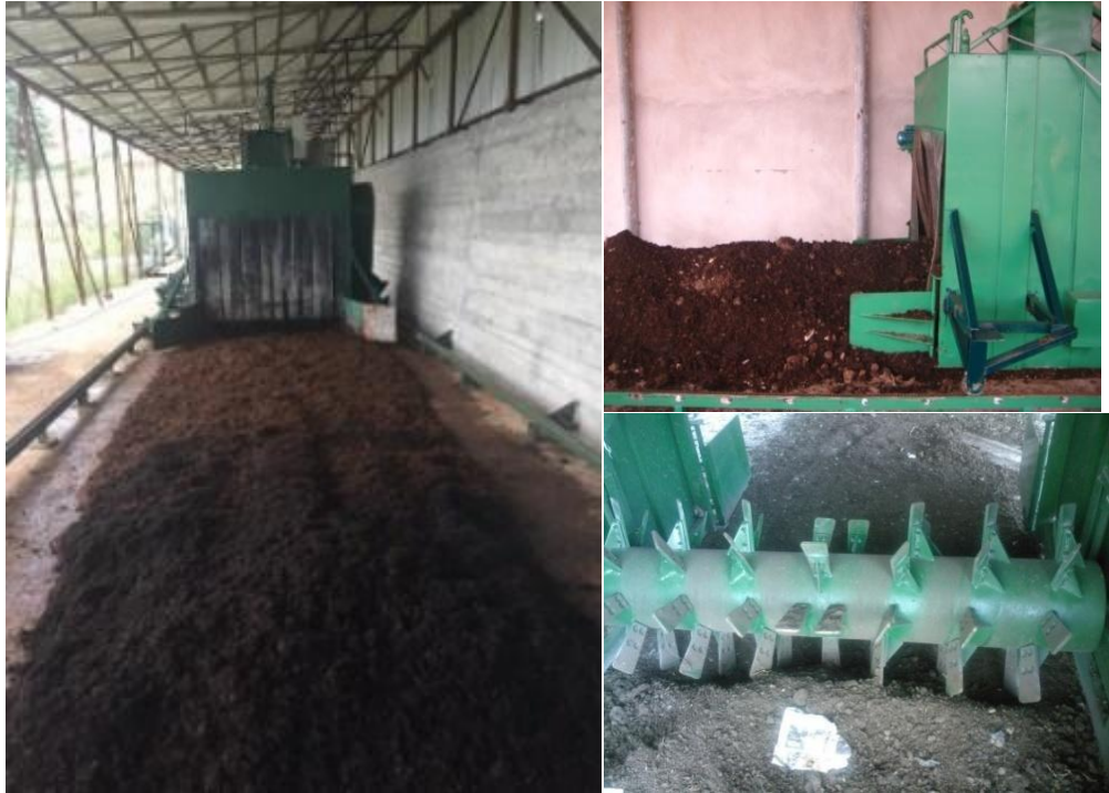
Şekil 3.5. Çay atıklarının kompostlanmasında kullanılan windrow kompostlayıcı
