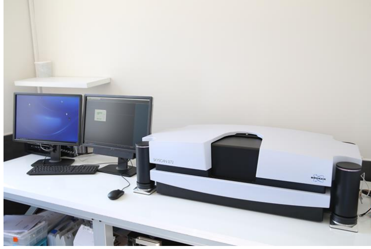
Resim 3 Mikro-bilgisayarlı tomografi çekiminde kullanılan SkyScan 1272 Mikro-BT cihazı.
