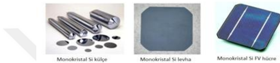
Şekil 3.10. Monokristal hücre üretim safhaları
