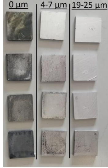
Şekil 3.21 : 24 saat korozif ortamda bekletilmiş numuneler.
