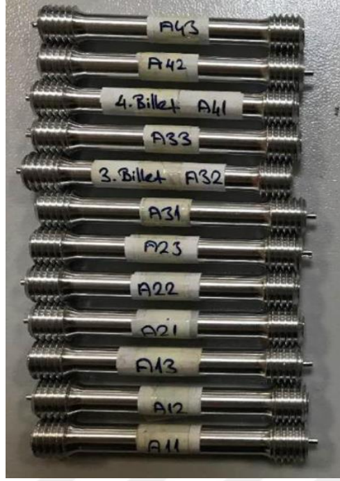
Şekil 3.16 : DIN 50 125 standardına göre hazırlanan çekme numuneleri.
