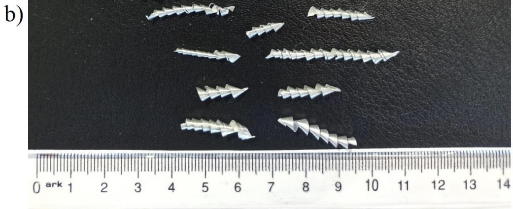
Şekil 3.18 : a) Talaş tipleri [60] b) Delik delme sonrası oluşan talaşlar.
