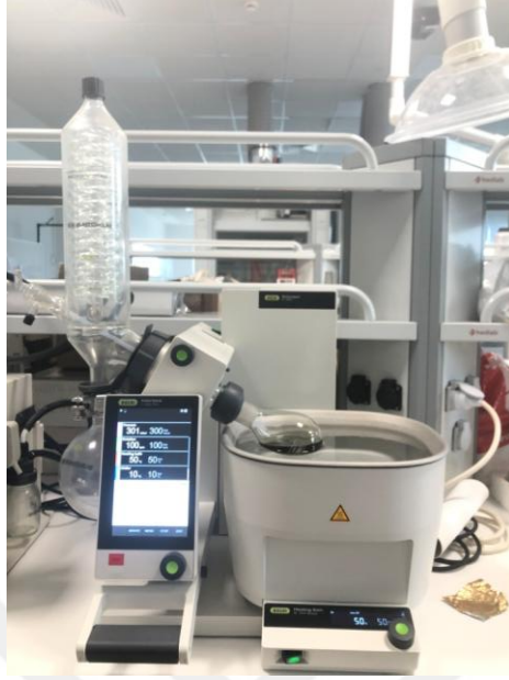
Resim 4. Distilasyon İşleminin Gerçekleştirildiği Rotary Evaporatör Cihazı (Buchi B-300 Base)
