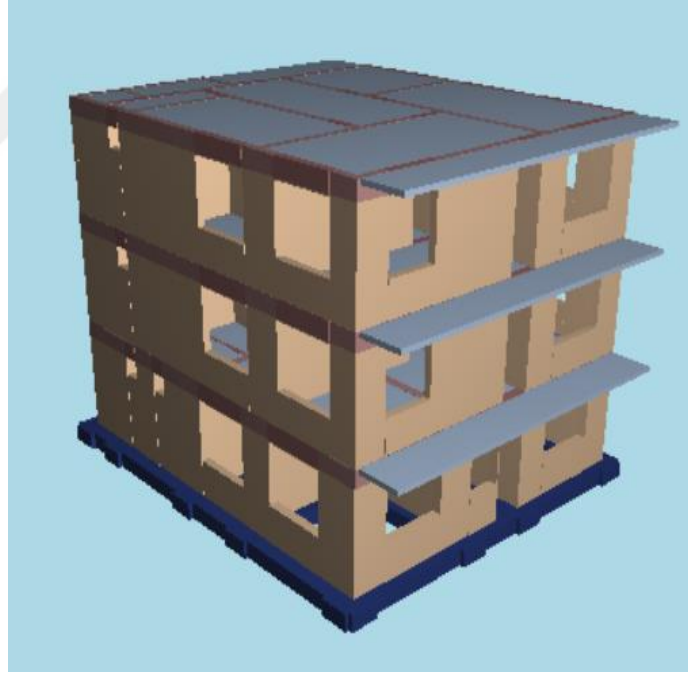
Şekil 4.11. Yığma konut binasının hesap modeli
