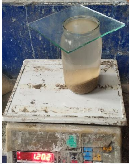
Şekil 3.11. Birim hacim ağırlık deneyinin yapılması
