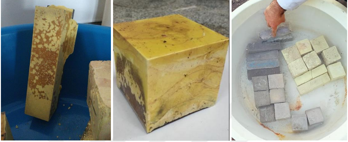
Şekil 3.9. Numunelerin suda ve laboratuvar ortamında kür edilmesi
