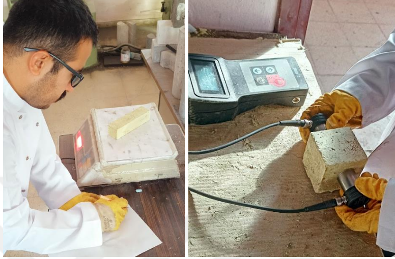
Şekil 3.10. Birim ağırlık ve ultrases geçiş hızı ölçümlerinin yapılması
