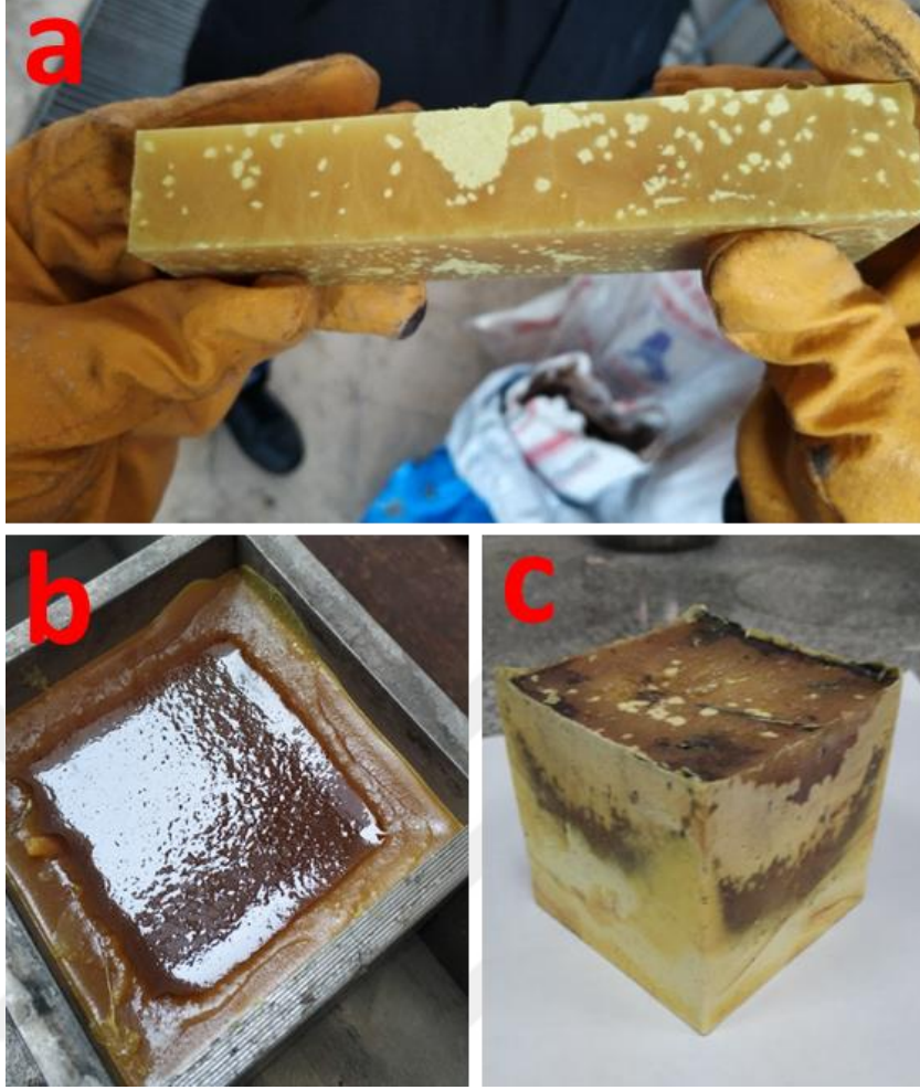
Şekil 3.8. Kükürlü betonların soğutulması ve kalıptan çıkartılması a) Prizmatik numunenin soğuma aşaması b) Küp numunenin soğuma aşaması c) Kalıptan çıkarılan numune
