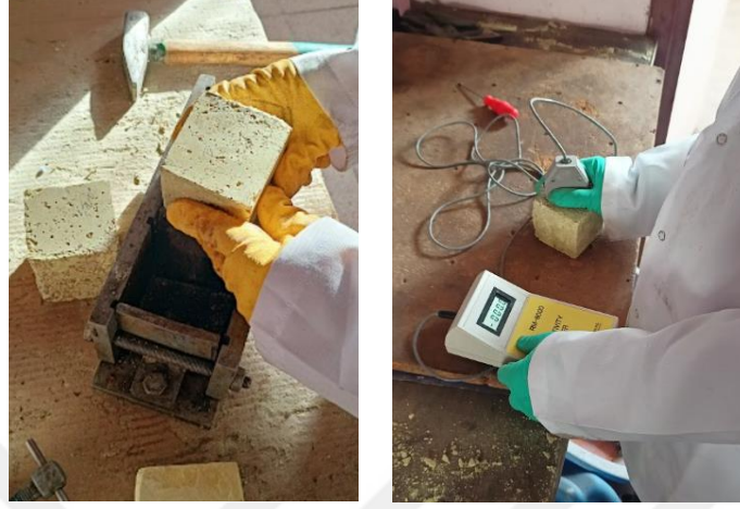
Şekil 3.13. Numuneler üzerinde elektriksel özdirenç deneyinin uygulanması
