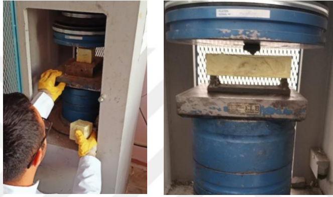
Şekil 3.12. Beton numunelerde basınç ve eğilme dayanım değerinin ölçümü
