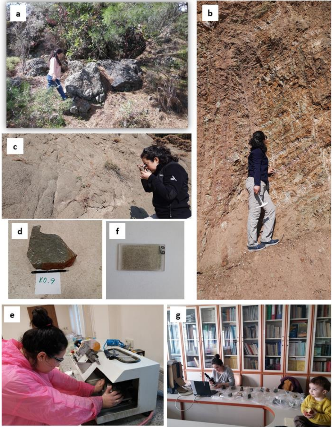
Şekil 3.1. a) Araziden günlenmiş kayaç yüzeyleri; b) yol yarmalarındaki taze kaya yüzeyleri; c) el mikroskobu ile inceleme; d) araziden alınan el örneği; e) örneklerin ince kesit ve spektrometre ölçümleri için kesilerek hazırlanması; f) ince kesit; g) ASD cihazı ile spektrometre ölçümü
