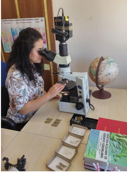
Şekil 3.9. İnce kesitlerin alttan aydınlatmalı polarizan mikroskobunda detaylı incelenmesi
