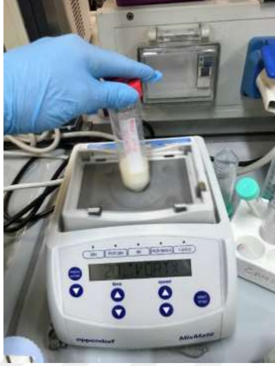
Şekil 3.6: Hücrelerin liziz tampon içerisinde vorteks yardımı ile süspansiyon edilmesi.
