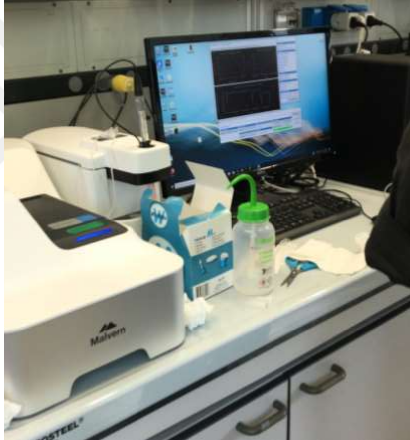
Şekil 3.18: Malvern Z-sizer enstrümanında Dynamic Light Scattering ile numunelerin analizi.
