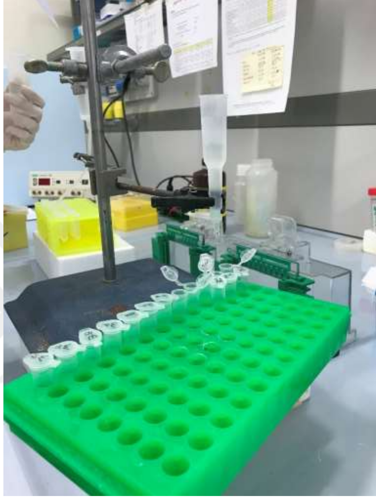
Şekil 3.9: Yıkama tamponu eklendikten sonra kromatografik kolon'dan geçirilerek safsızlıkların giderilmesi.
