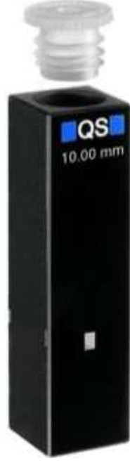
Şekil 3.16: DLS enstrümanında numunelerin analiz edildiği kuvars küvet.
