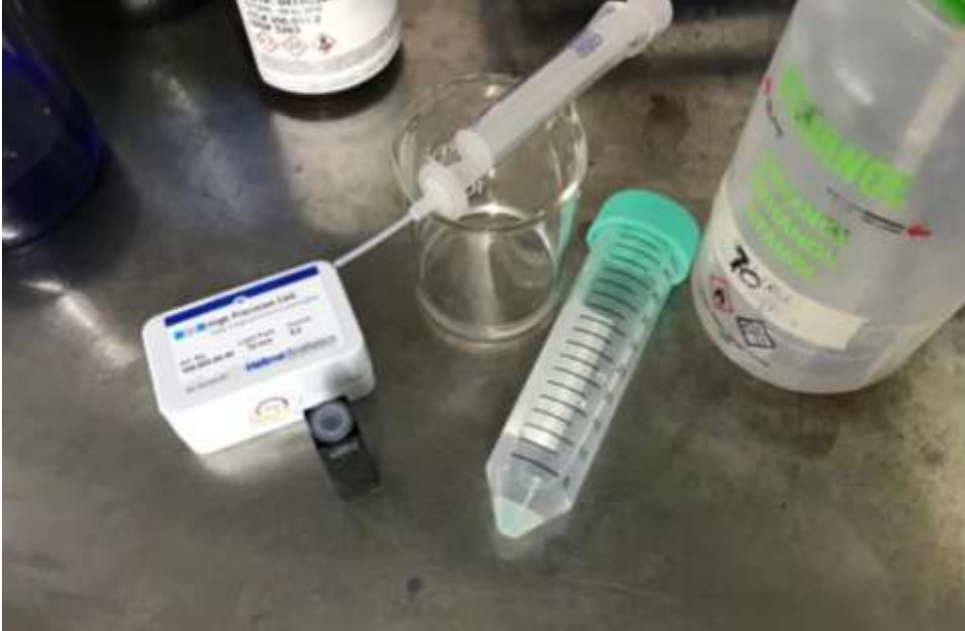
Şekil 3.17: Numune analizinin yapılacağı kuvars küvetin EtOH ile temizlenmesi.
