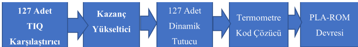
Şekil 1.1. TIQ Flash ADC Blok Diyagramı
