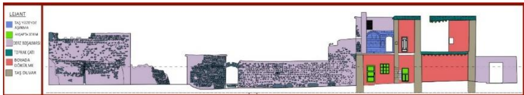
Şekil 5.48. G-G Kesiti ve Z3 Avlu Doğu Cephesi Bozulma Analizi
