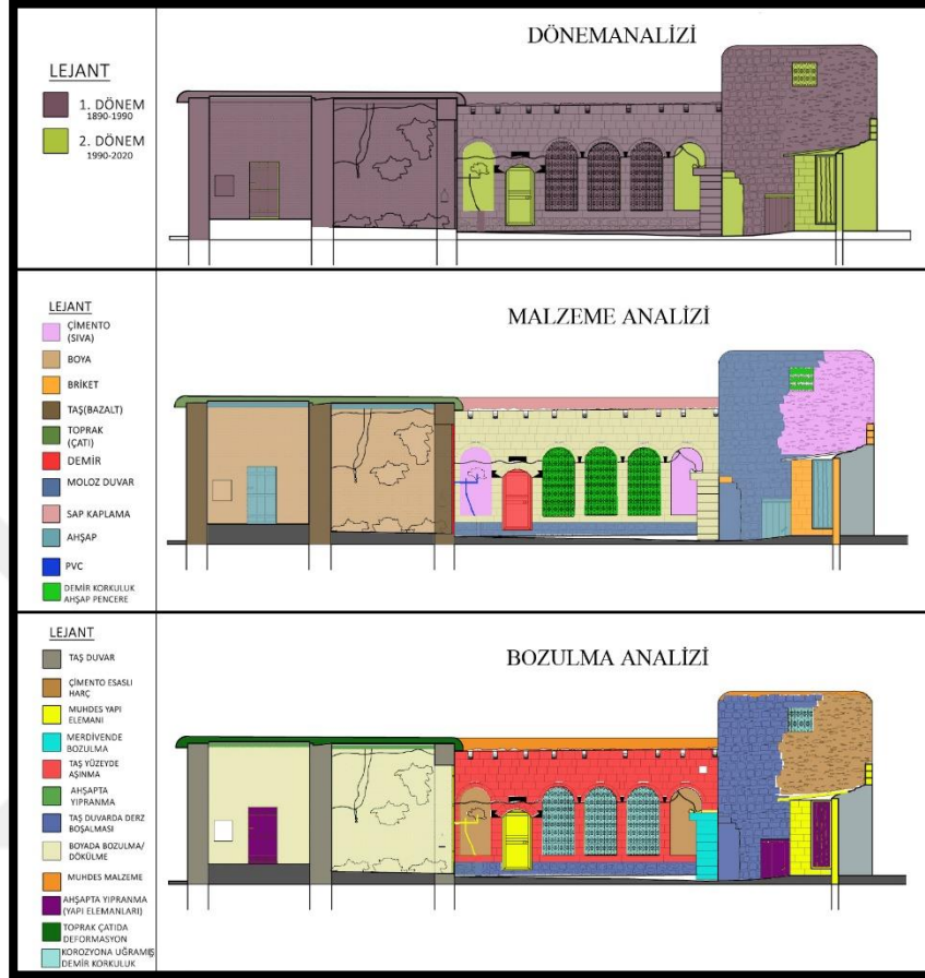
Şekil 3.102. B-B Kesiti ve Avlu Batı Cephesi
