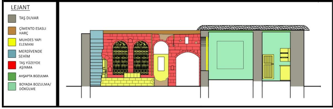
Şekil 3.49. A-A Kesiti ve Avlu Güney Cephesi Bozulma Analizi
