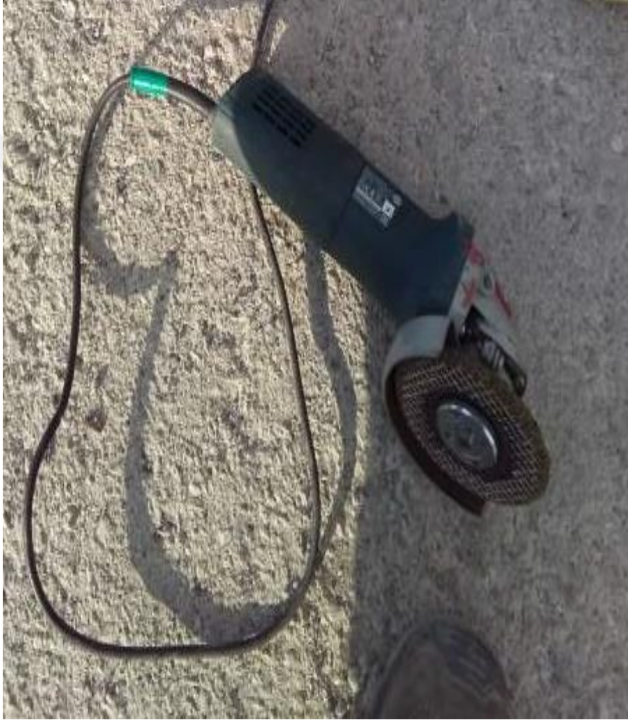
Şekil 3.51. Koruma Bantlı Elektrikli El Aleti
