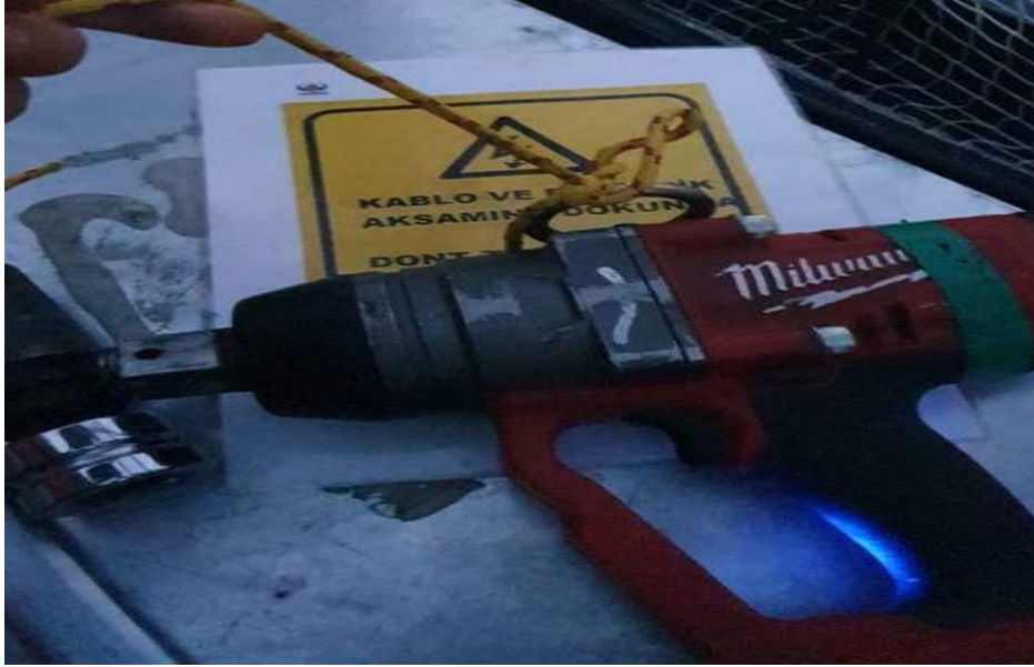
Şekil 3.53. El Aletlerinin Bağlanması Örneği
