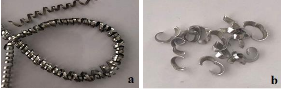
Şekil 5. 18. MQL işleme şartlarında kriyojenik işlem görmemiş kesici takım ile elde edilen talaşlar a) V=160 m/dak f=0,1 a=2 mm b) V=250 m/dak f=0,25 a=2 mm
