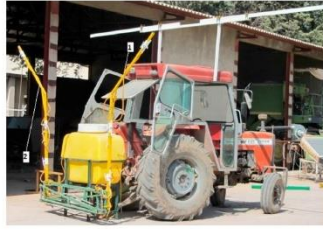
Şekil 1.22. Kamera tabanlı oluşturulan değişken oranlı püskürtme sistemi ve sistemde kullanılan kameraların yerleşimi (Asaei, Jafari and Loghavi, 2019)
