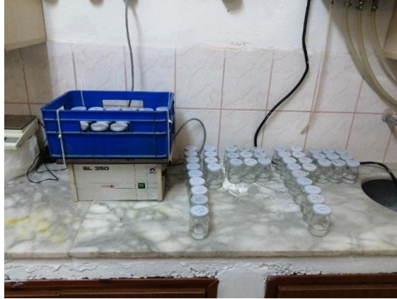
Şekil 3.37. İçerisine saf su eklenen kavanozların çalkalanması
