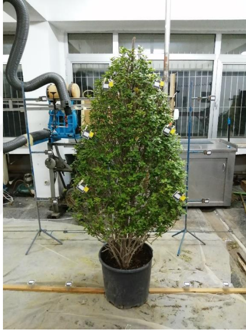
Şekil 3.30. Suya duyarlı kâğıtlarının deneme düzeninde yerleştirilmiş hali (ön görünüş)
