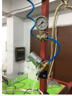
Şekil 3.13. Manometre ve koç darbesi sönümleyicisinin montaj hali
