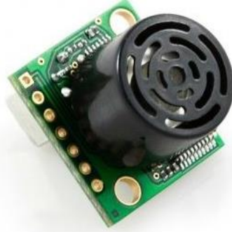
Şekil 3.4. Prototip püskürtme sisteminde kullanılan ultrasonik sensör
