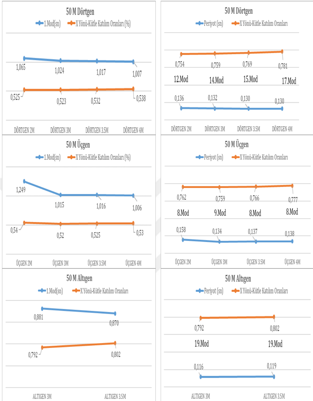
Şekil 6.7. 50 Metre açıklık için oluşturulan modellerin modül geometrisine göre periyot ve kütle katılım oranına göre karşılaştırılması
