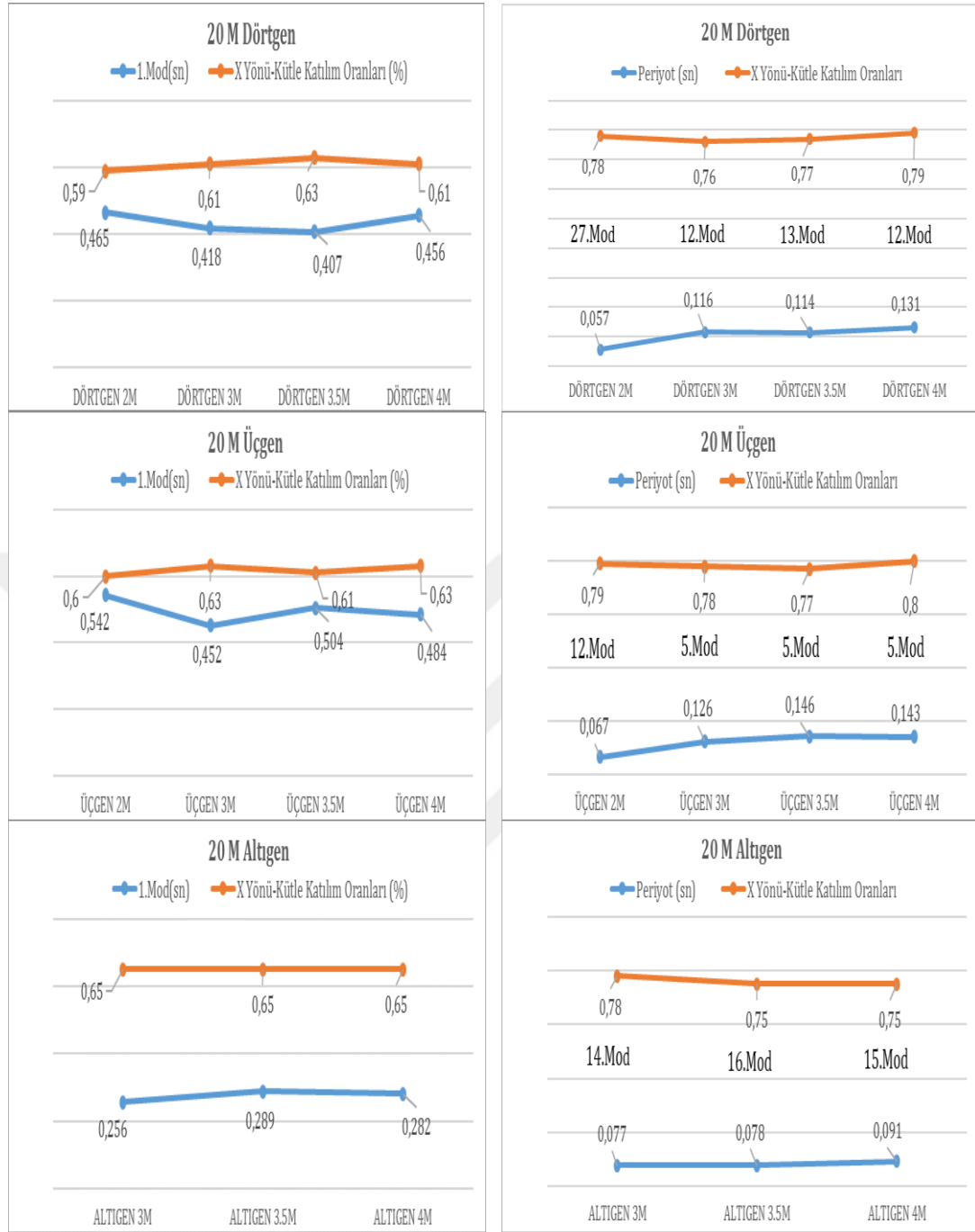
Şekil 6.1. 20 Metre açıklık için oluşturulan modellerin modül geometrisine göre periyot ve kütle katılım oranına göre karşılaştırılması
