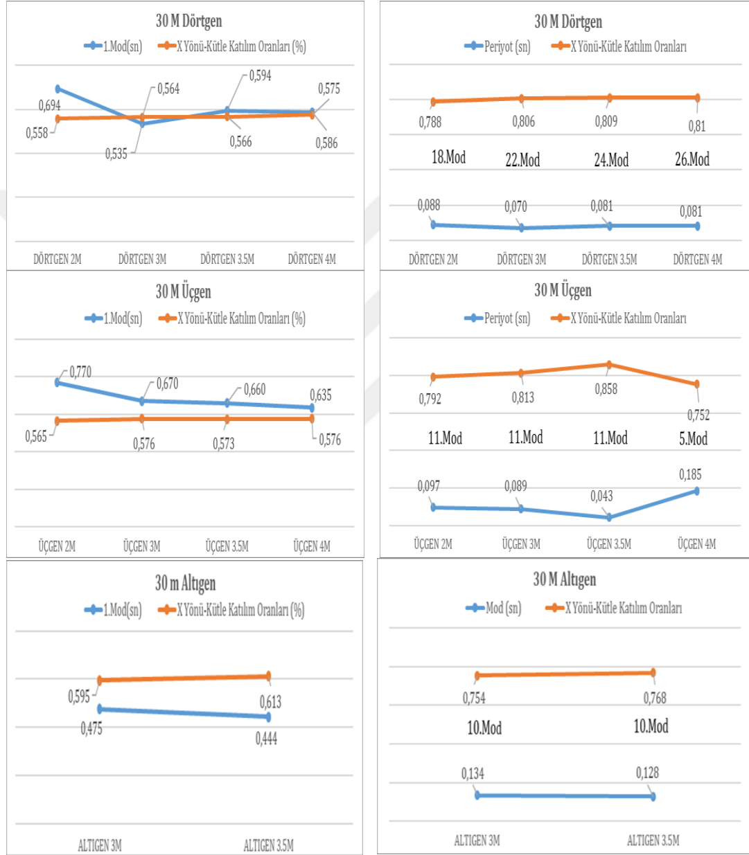
Şekil 6.3. 30 Metre açıklık için oluşturulan modellerin modül geometrisine göre periyot ve kütle katılım oranına göre karşılaştırılması
