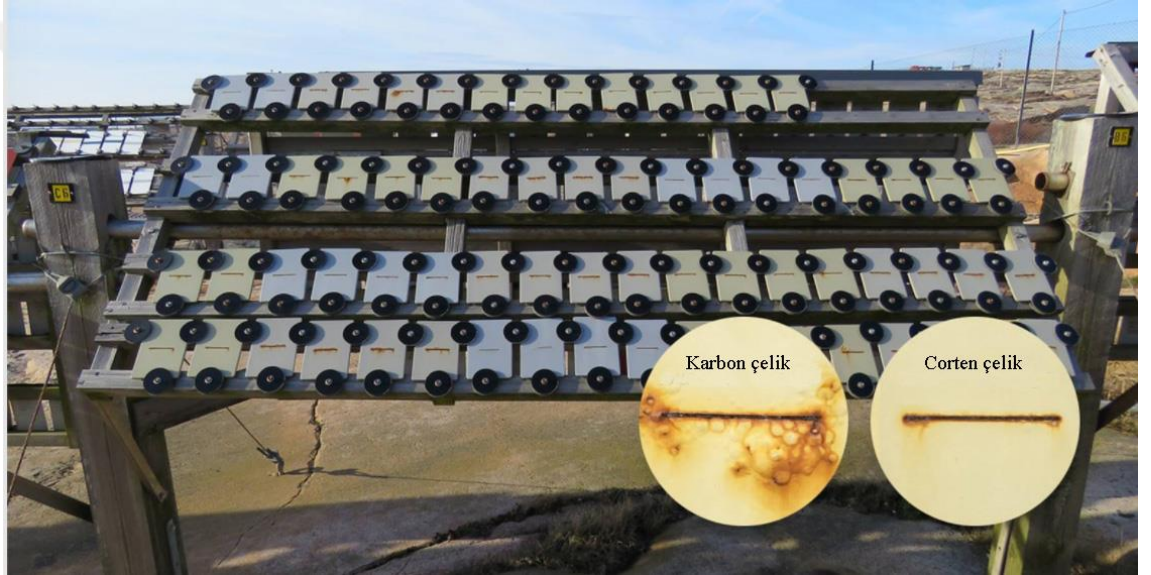
Şekil 2. 37. Boyanmış karbon çelik ve corten çelik karşılaştırılması (SSAB, 2022)
