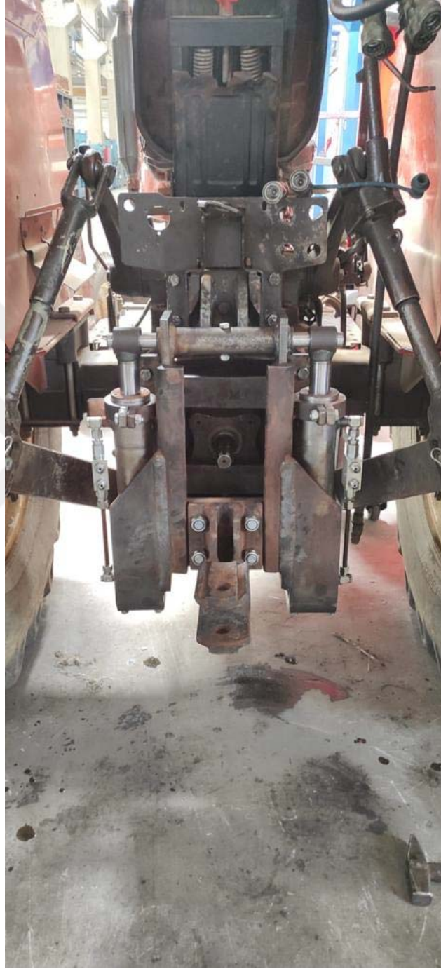
řekil 4.29. Aparat Çeki Demirinin Kızağa Bağlanması
