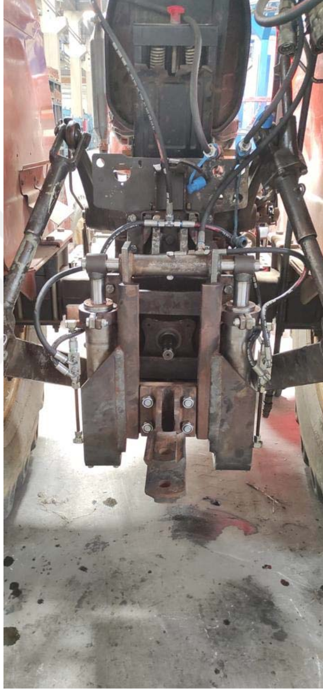
řekil 4.30. Piston Hortumlarının Baęlanması
