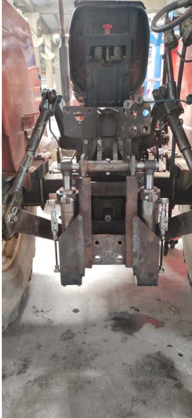
řekil 4.28. Kızağın Bağlantı Mili ile Pistonlara Bağlanması
