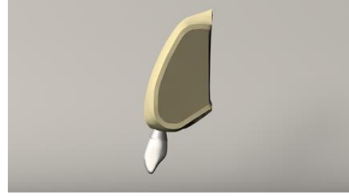
Şekil 3. 13 Metal alt yapının(krom-kobalt alaşımı) farklı açılardan görünümü.
