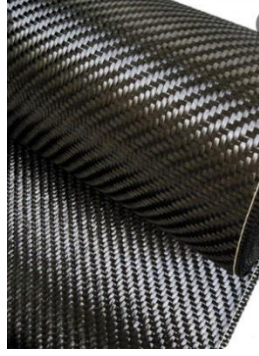
Şekil 3.9: 200 g/m 2 dimi dokuma kumaş yapısı
