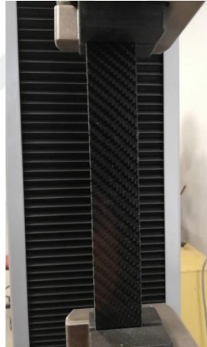
Şekil 4.17: 245 dimi dokuma tipinde çekme numunesinin cihazına bağlanması
