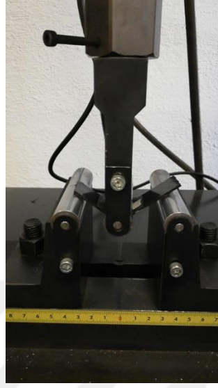
Şekil 4.19: Üç nokta eğme test cihazı ve numunenin cihaza yerleştirilmesi
