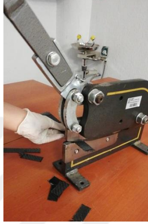
Şekil 4.9: Numunelerin giyotin makas ile kesilmesi
