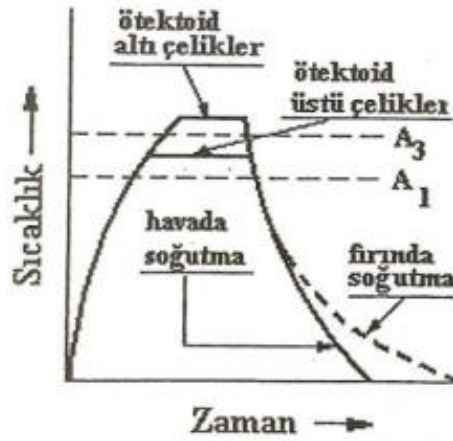
Şekil 4.8. Normalizasyon ısıl işlemine ait zaman-sıcaklık diyagramı [52].
