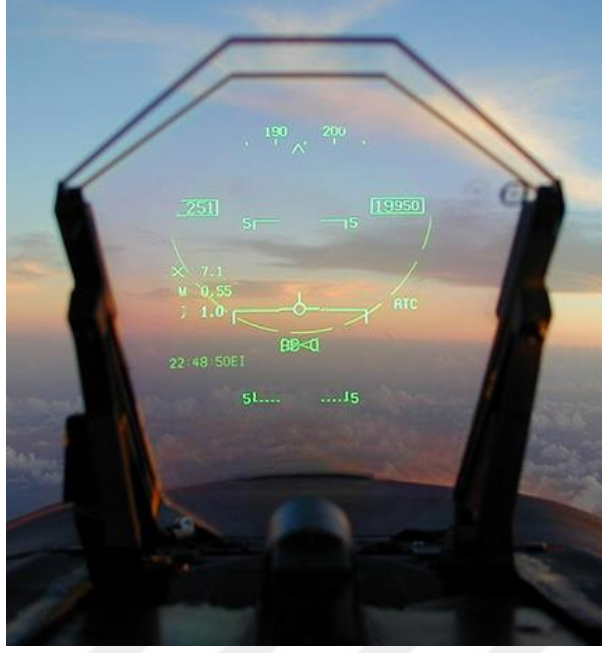
Şekil 2.3. HUD Sisteminin Havacılıkta Kullanımı (Anonim, 2015)
