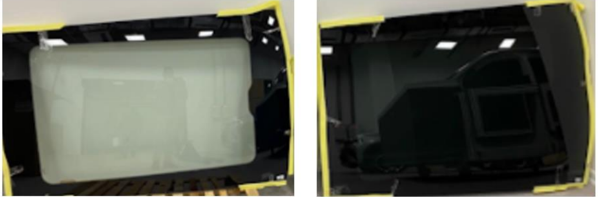
Şekil 2.9. Renksiz ve Renkli PVB Kullanımı Karşılaştırılması
