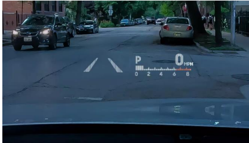
Şekil 2.4. HUD Sisteminin Otomotive Entegrasyonu (Anonim, 2021)
