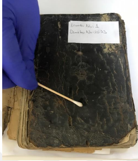
Resim 5.7. 1 numaralı örneklem eserden biyolojik bozulma için sürüntü örneğinin alınması (Mustafa Kartal, 2022)
