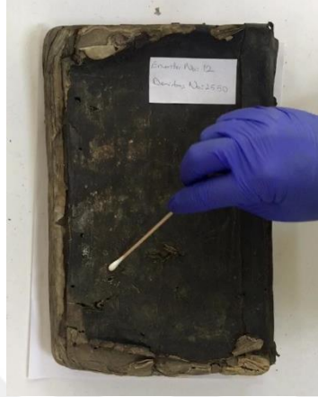
Resim 5.13. 4 numaralı örneklem eserden biyolojik bozulma için sürüntü örneğinin alınması (Mustafa Kartal, 2022)
