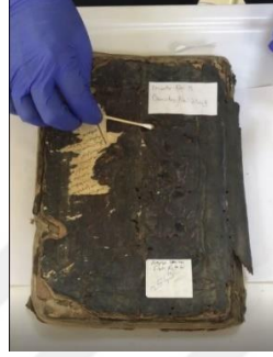
Resim 5.11. 3 numaralı örneklem eserden biyolojik bozulma için sürüntü örneğinin alınması (Mustafa Kartal, 2022)
