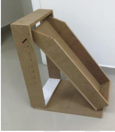
Şekil 17: Eğimli tablada deneklerin tutunabilme açısının saptanması.
