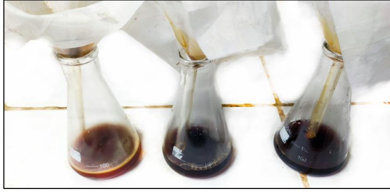
Şekil 3.4 Hidroliz sonrası ipek elekten süzülme.
