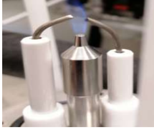
Şekil 4.8. Metal yanma odasında, \text{CH}_4 gazının tam yanması
