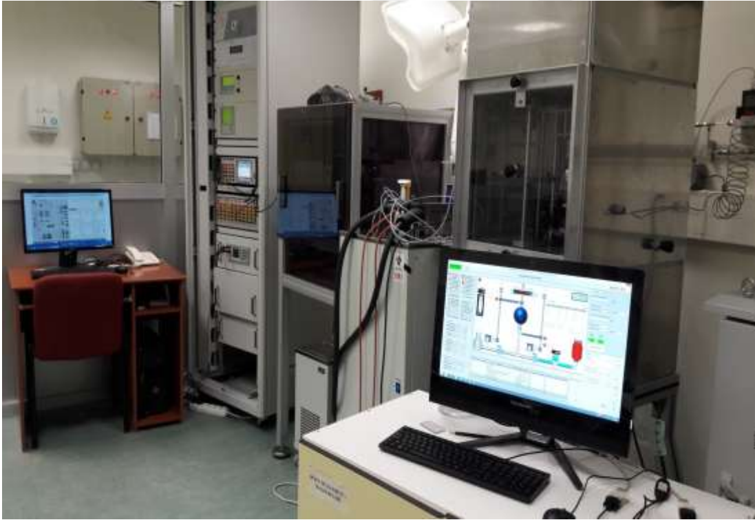
Şekil 3.2. Referans gaz kalorimetre sisteminin laboratuvar düzeni
