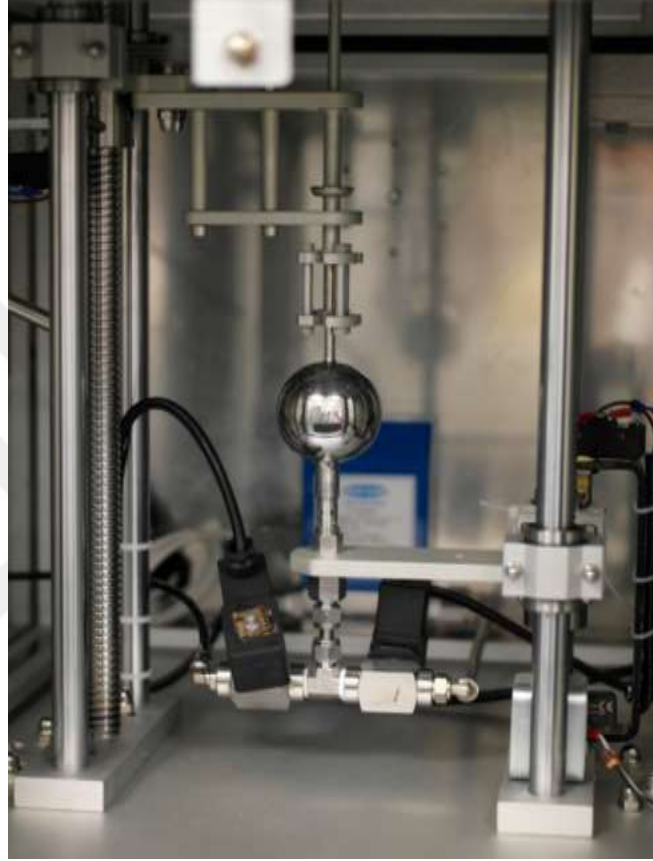
 ekil 3.4. K tle  l  m sisteminde kullanılan gaz k resinin genel g r n    
