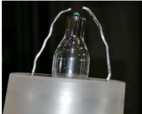
Şekil 4.7. Cam yanma odasında, CH 4 gazının tam yanması
