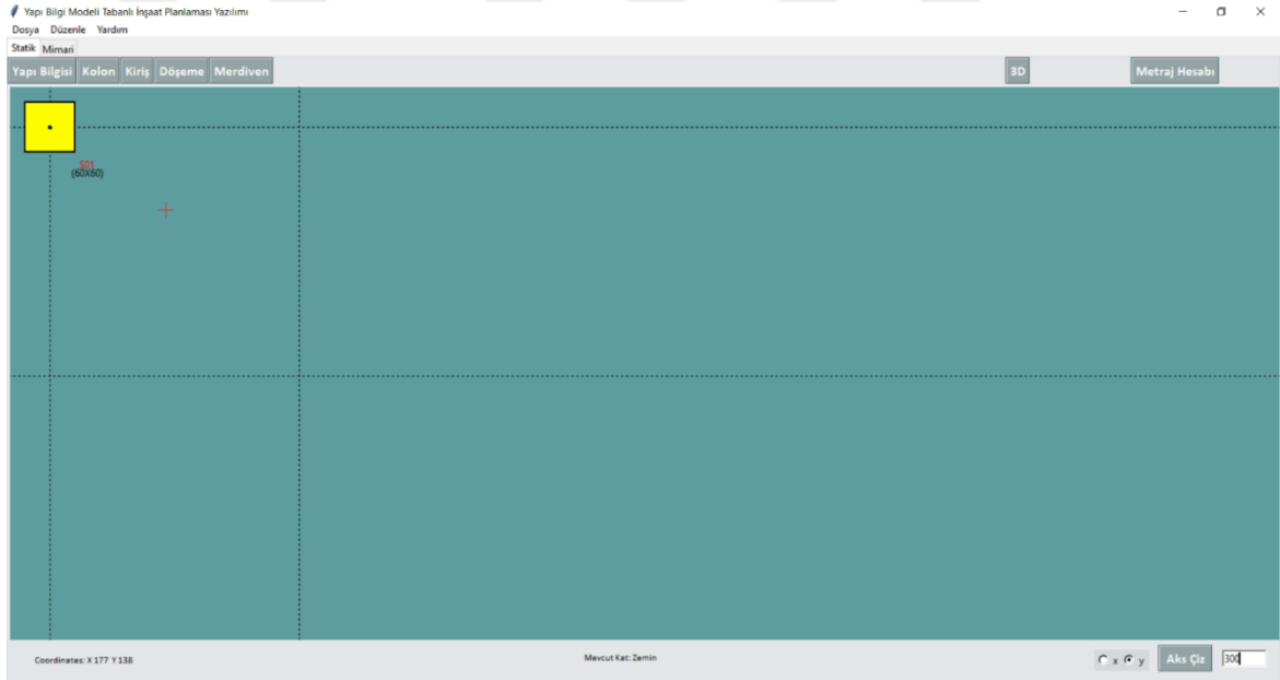
Şekil 3.7: Kolonun çiziminin yapılacağı aksların kesiştiği noktaya farenin sol tuşu ile tıklanması
