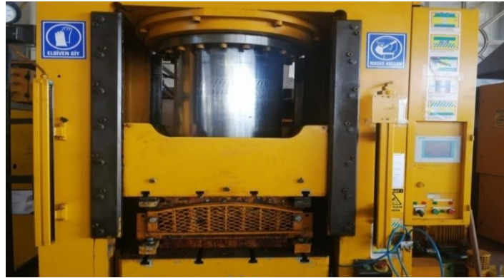
Resim 3.17 Test plakalarının hidrolik preste basımı.
