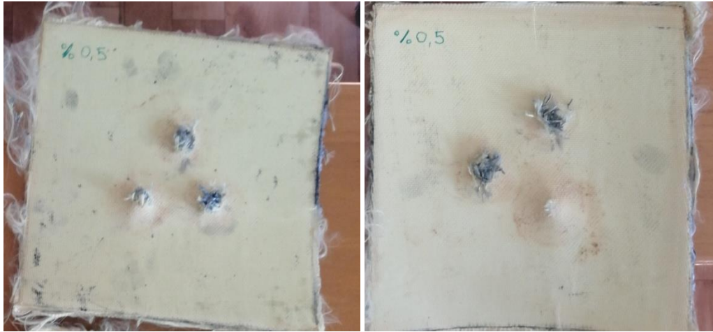
Resim 4.3 Atış yapılan plakanın arkadan görünümü (%0,5 grafen katkılı).
