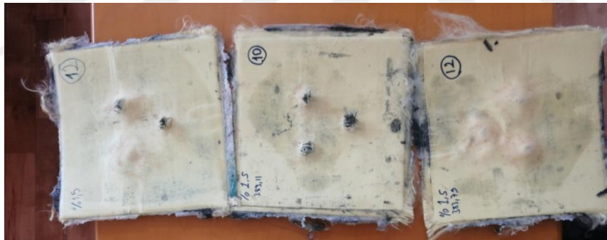
Resim 4.5 Atış yapılan plakaların arkadan görünümü (% 1,5 grafen katkılı).
