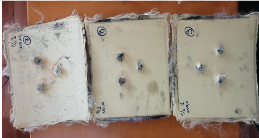
Resim 4.4 Atış yapılan plakanın arkadan görünümü (% 1 grafen katkılı).
