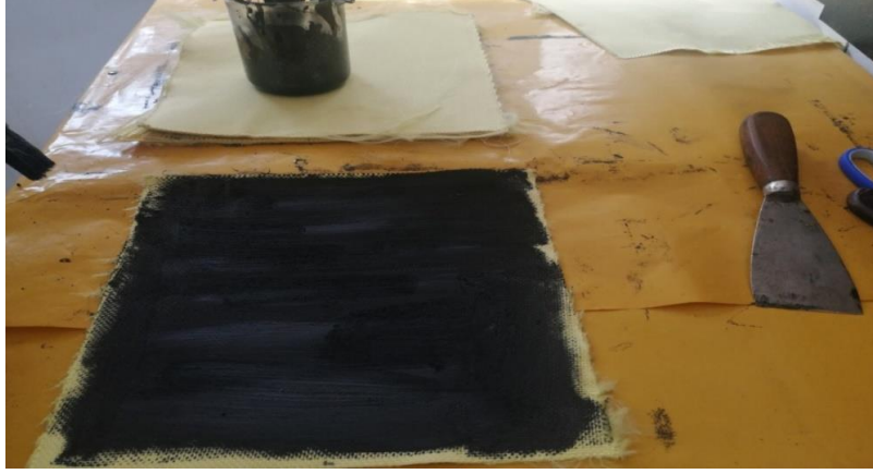
Resim 3.16 Aramid katmanlara grafen karışımının sürülmesi.
