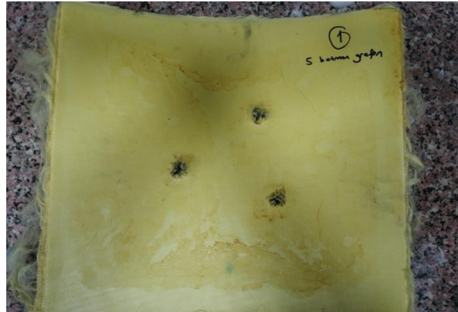
Resim 4.6 Grafen katkılı aramid plaka atış sonrası görünümü.
