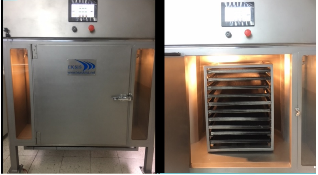
Şekil A.2. Çileklerin kurutulmasında kullanılan PLC kontrollü kurutucu.
