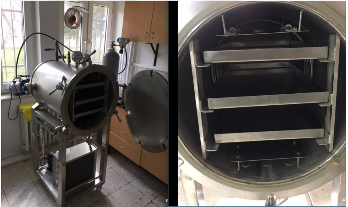
Şekil A.3. Karbonik maserasyon uygulanan sıcaklık ve basınç kontrollü tank.
