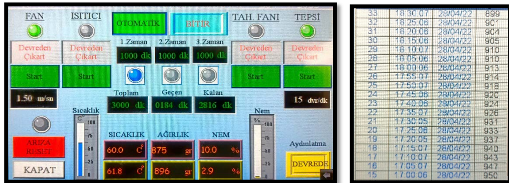
Şekil 3.4. Kurutma fırını PLC kontrol ekranı ve ağırlık takibinin bir görüntüsü
